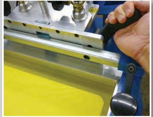
Conveniente ajuste fuera de contacto accionado por palanca
